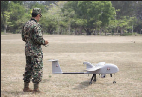
Vehículo Aéreo No Tripulado (VANT) que se caracteriza por contar con una envergadura de 1,78 metros, 1,33 metros de longitud y dos kilómetros de alcance.
