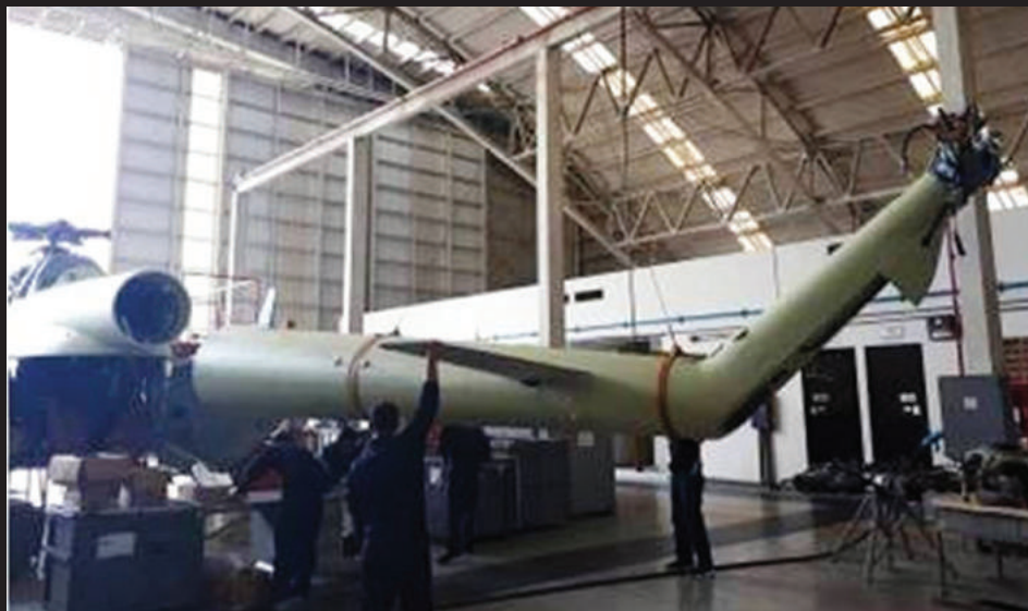
Ensamble de un helicóptero Mi-17 posterior a reparación mayor.
