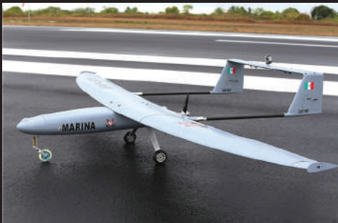
El Spartaam, con capacidad de transmitir imagen y vídeo en tiempo real, dos horas de autonomía, alcance máximo de 50 millas náuticas, altitud operacional de 13.000 pies, envergadura de 4,80 metros y una longitud de 2,70 metros.
