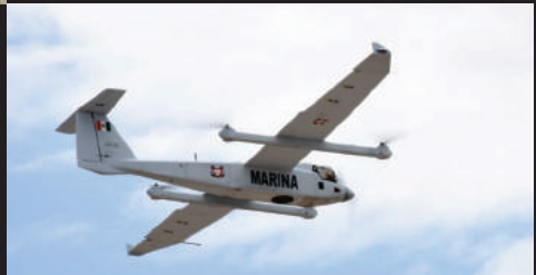
El Arcturus T-20, cuyas características son: 2,89 metros de largo y una envergadura alar de 5,36 metros, un peso de 84 kilogramos y una autonomía de hasta 16 horas.
