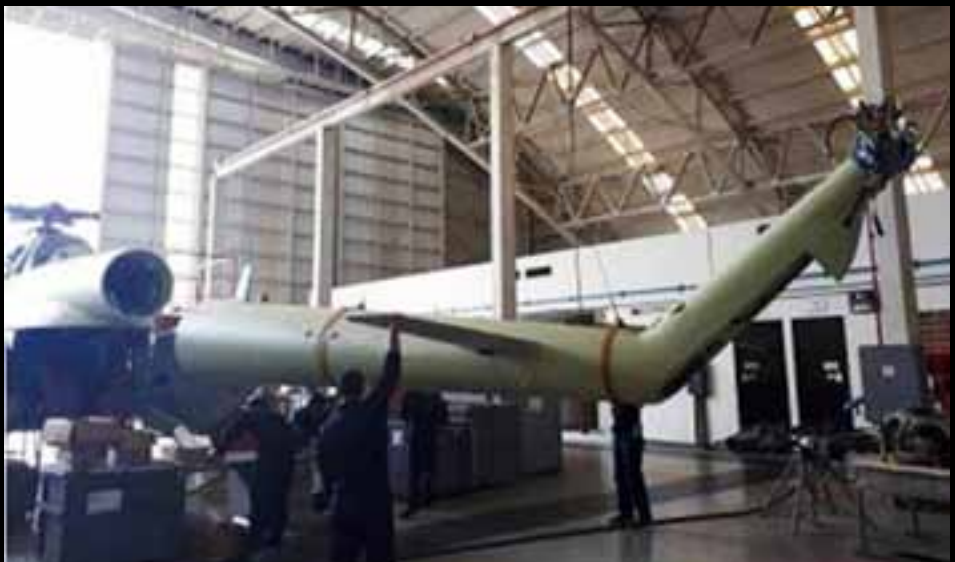
Ensamble de un helicóptero MI-17 posterior a reparación mayor.
